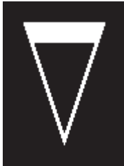
Figur 22.2.6.1-1, förberedande upplysning om väjnings- el. stopplikt.
