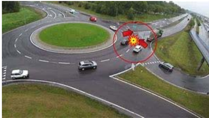
Figur 22.3.11.5-4, Bild som visar problem som kan uppstå vid två körfält i cirkulationen.
